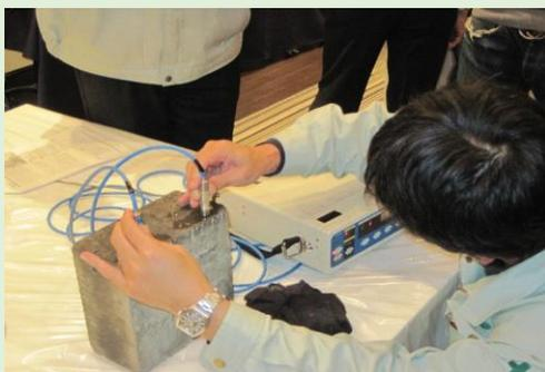
・鉄筋探査(電磁誘導法)
